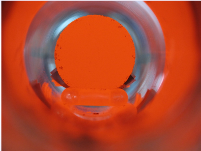
Dotieren mit Phosphor im Diffusionsofen bei 900°C
